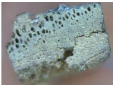
Fig. 2 – Pentecostes – secção transversal da amostra – fotografia microscópio portátil - 50x –. ©Maria João Sousa.
